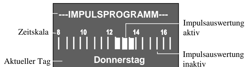
Abbildung 21: Ansicht des Impulsprogramms. Durch Drehen im Uhrzeigersinn können die Einstellungen von 0 bis 24:00 betrachtet werden.
