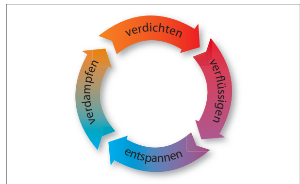
Abb.: Kreisprozess einer Wärmepumpe
