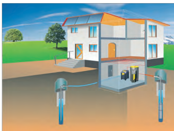
Abb.: Aufbau einer Erdwärmelanlage mit Grundwasser
